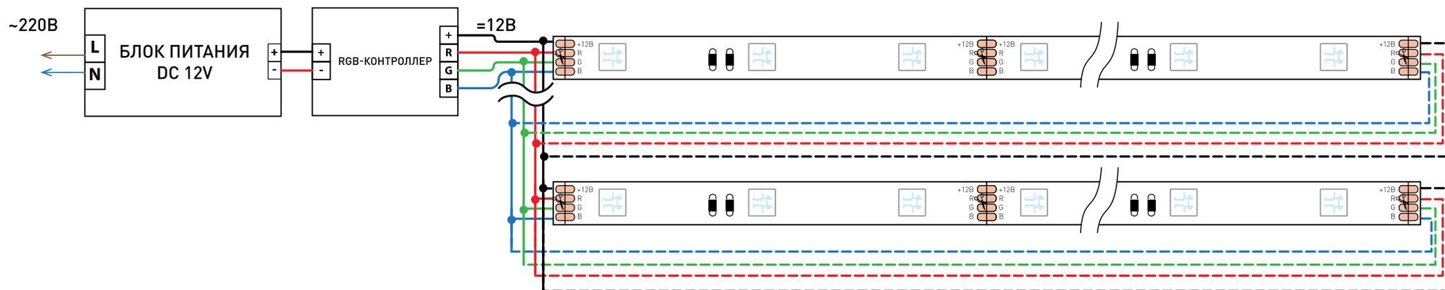
4. Ленту можно разрезать на отрезки с минимальным количеством светодиодов. Каждая линия отреза отмечена черной полоской и по обе стороны имеет две пары контактных площадок для дальнейшего соединения.
