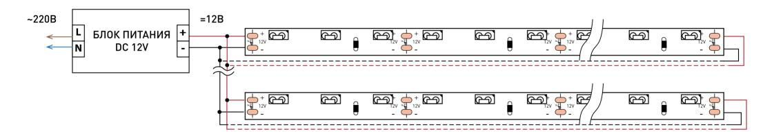
4. Ленту можно разрезать на отрезки с минимальным количеством светодиодов. Каждая линия отреза отмечена черной полоской и по обе стороны имеет две пары контактных площадок для дальнейшего соединения.
