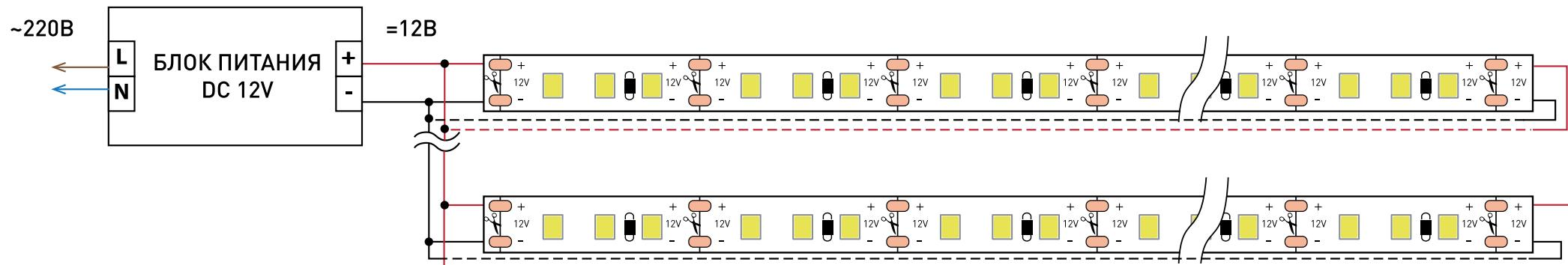
4. Ленту можно разрезать на отрезки с минимальным количеством светодиодов. Каждая линия отреза отмечена черной полоской и по обе стороны имеет две пары контактных площадок для дальнейшего соединения.
