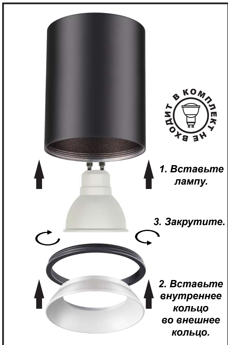
Схема сборки накладного светильника.
