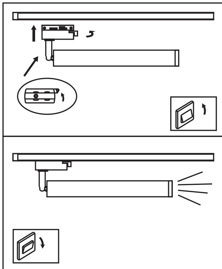
**ВНИМАНИЕ.** Все работы по монтажу шинопровода и установке светильников, замене ламп и техническому обслуживанию следует проводить при отключенном напряжении питания шинопровода. Категорически запрещается производить перемещение светильников вдоль шинопровода во включенном состоянии.
