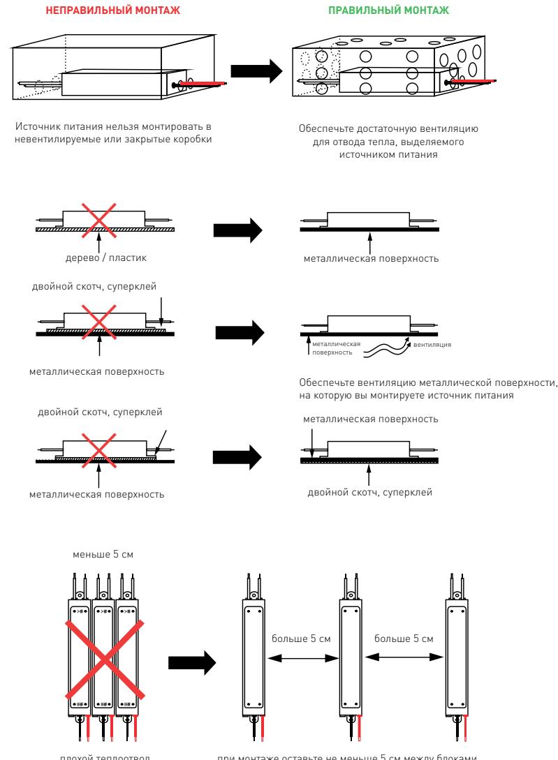
2. По возможности, устанавливайте блок питания на металлическую поверхность, не используйте прокладок, затрудняющих теплоотвод.
